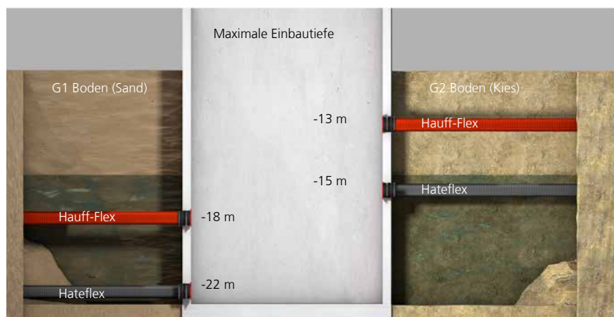
Maximale Verlegetiefe von Kabelschutzschläuchen
